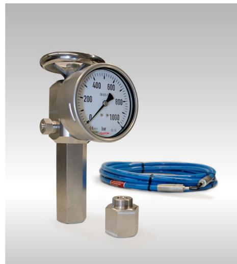
Устройство FPU-2 разработано специально для работы с высоким давлением. Как и FPU-1, устройство FPU-2 может использоваться универсально. Оно может навинчиваться непосредственно на баллонные и мембранные аккумуляторы HYDAC для их наполнения и/или проверки. Для использования с баллонным аккумулятором предназначен адаптер высокого давления A3H. По умолчанию он не входит в комплект поставки.
