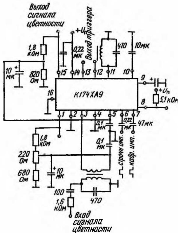
Типовая схема включения
