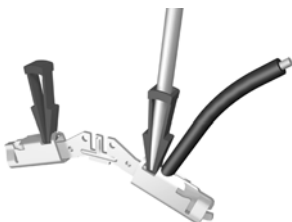
Принцип работы технологии с прорезанием изоляции
